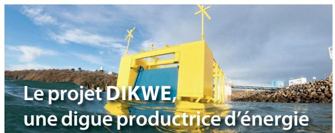
**Initié en 2020 par la rencontre des besoins du groupe Legendre et de l'expertise de GEPS Techno en matière de solutions maritimes durables, le projet Dikwe vise à développer une solution d'ouvrage de protection du littoral qui intègre un dispositif de production d'énergie renouvelable fondé sur un système houlomoteur à volets oscillants.**
